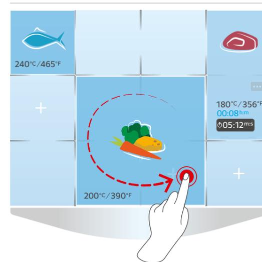
Eins, zwei, drei, vier. Die benötigten Tiegelzonen werden über iZoneControl mit einem Fingertipp über das Display bedient. Einfach und sicher.
